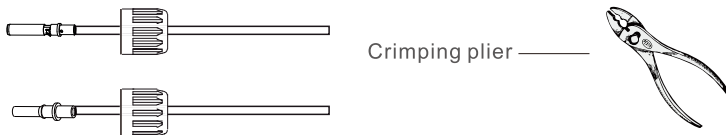
Rys. 3.4 Zaciskanie styku na przewodzie
